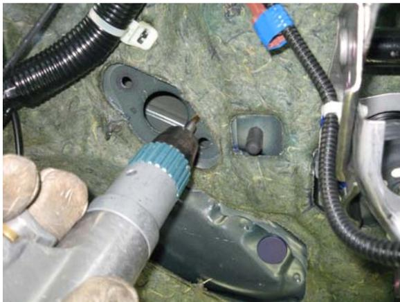
14. Efetue a proteção contra corrosão da área perfurada (interior e exterior) com um “spray de zinco” comercialmente disponível.
