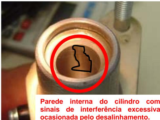
**Parede interna do cilindro com sinais de interferência excessiva ocasionada pelo desalinhamento.**
